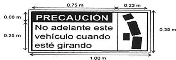
Figura Nº 1 Características de la señalización del VCC
