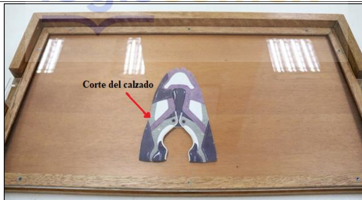
Figura N° 02. El corte del calzado dentro del sistema de trazo (corte ubicado entre el soporte y el acrílico transparente)
